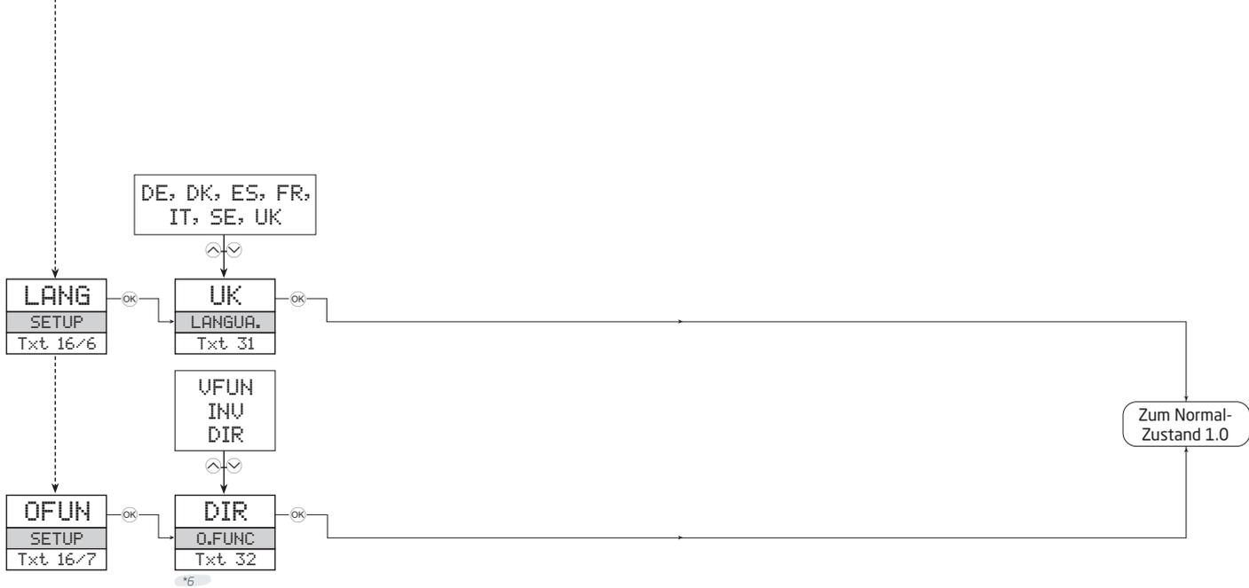
\*6 VFUN (V-förmige Ausgangsfunktion) ist nur verfügbar, wenn ein bei Null beginnender Ausgangsbereich ausgewählt wurde.
